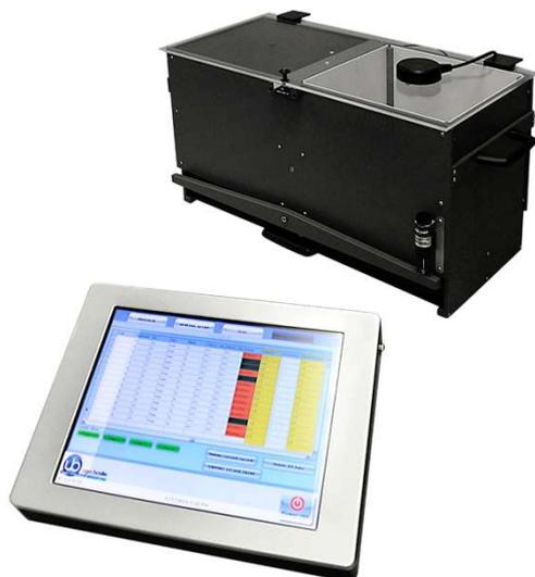
コントロールユニットは直感的な電子ユニットディスプレイによって最大4つのケージを制御します。タイムライン機能により、フレキシブルなスケジュールで様々な回避実験を行うことが可能です。定電流高精度8極ショッカーを内蔵し、データ取得を管理します。取得したデータはユニット内に保存され、PCへエクスポートすることでExcelやAccessなどで開き、詳細を解析することができます。
